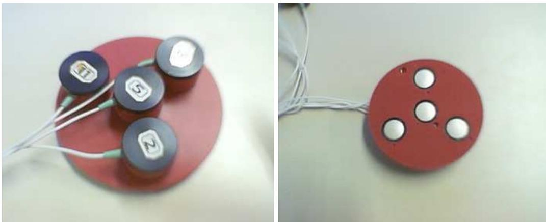
FIG. 2.2 – Les groupes de transducteurs (capteurs) d'Actifoetus. Chaque groupe est composé de quatre transducteurs ultrasonores maintenus entre eux par un support en silicone souple.
